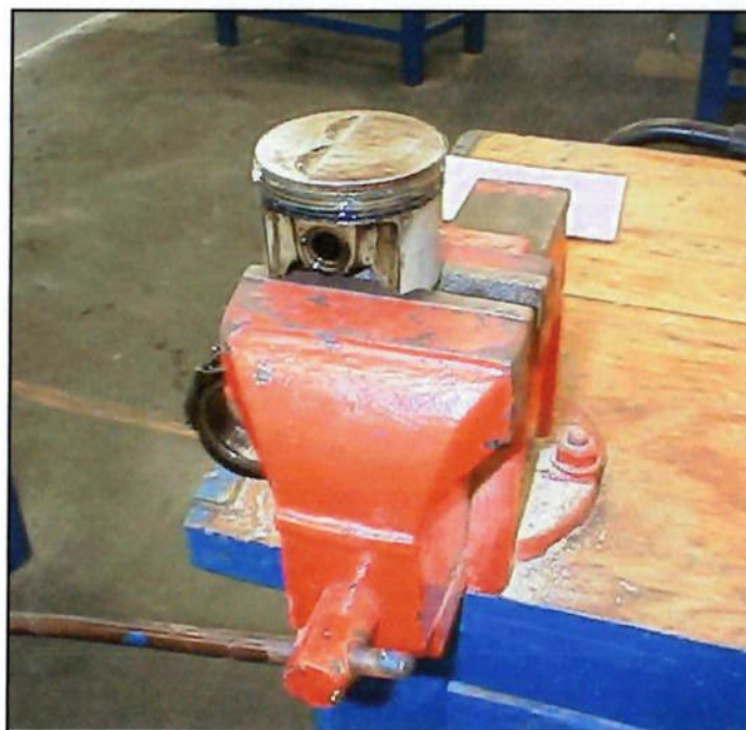
Figura 5.6.1 – Maneira correta de fixação: prende-se a biela com o mordente e encosta-se a saia do pistão na parte superior do mordente.
