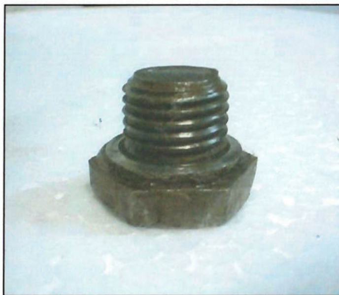
Figura 5.1.2 – Bujão com sua arruela de vedação em boas condições.
