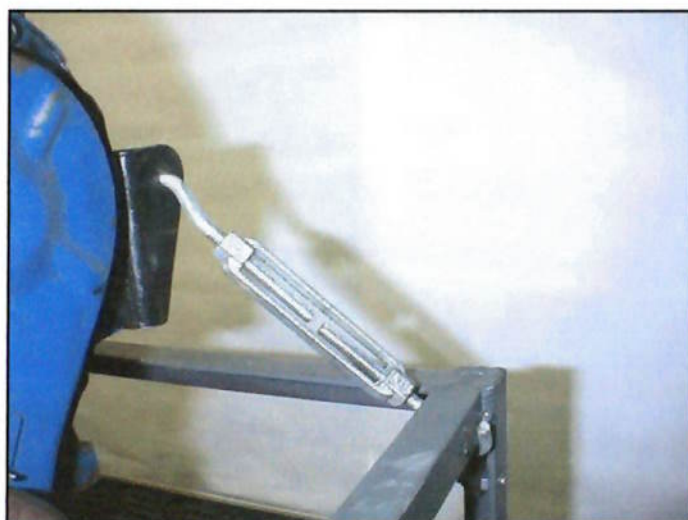
Figura 5.2.1 – Detalhe do esticador, que deve ser desrosqueado para afrouxar a correia.
