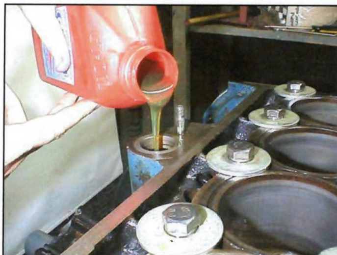
Figura 5.14.1 – Colocação do óleo pelo orifício sobre a engrenagem de acionamento da bomba de óleo.
