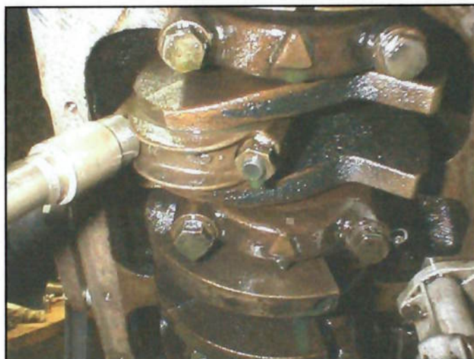
Figura 5.4.1 – Remoção dos parafusos das capas de bielas.
