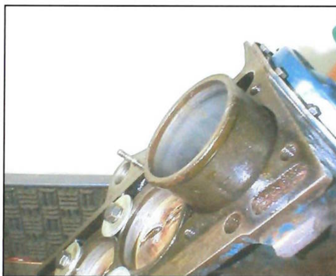
Figura 5.5.2 – Retirada da camisa do bloco.
