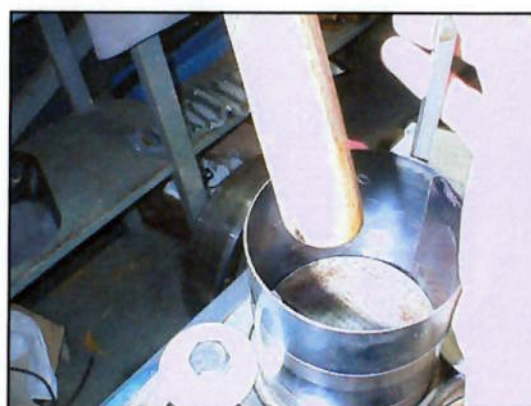
Figura 5.9.2 – Transporte do pistão de dentro da cinta para dentro da camisa.
