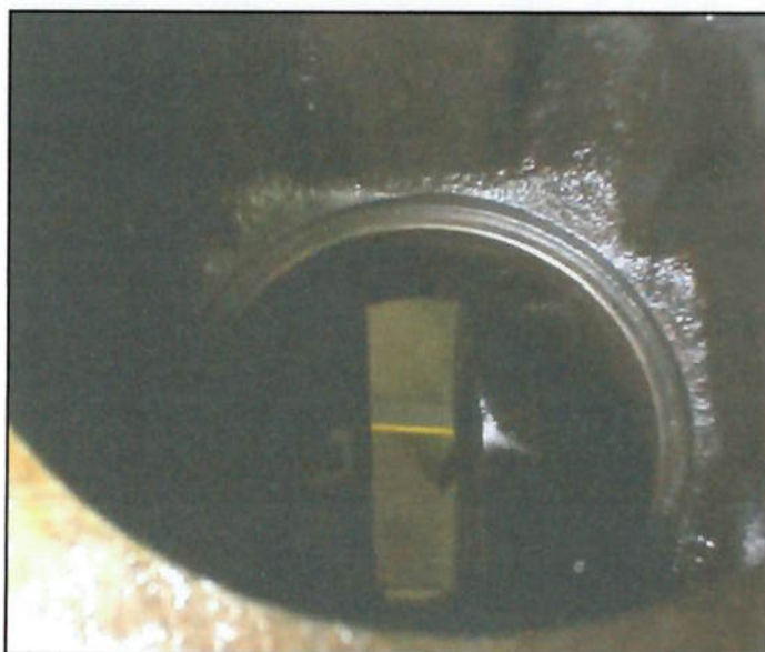
Figura 5.8.1 – Detalhe do assento da camisa no bloco.
