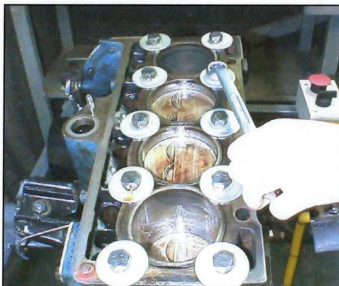
Figura 5.5.1 – Remoção dos parafusos que prendem as camisas aos bloco.
