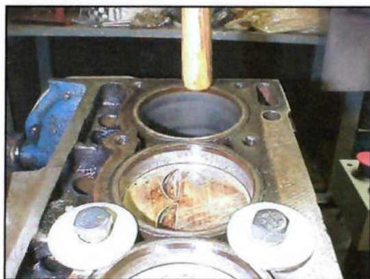
Figura 5.8.2 – Assentamento da camisa no bloco com leves pancadas.
