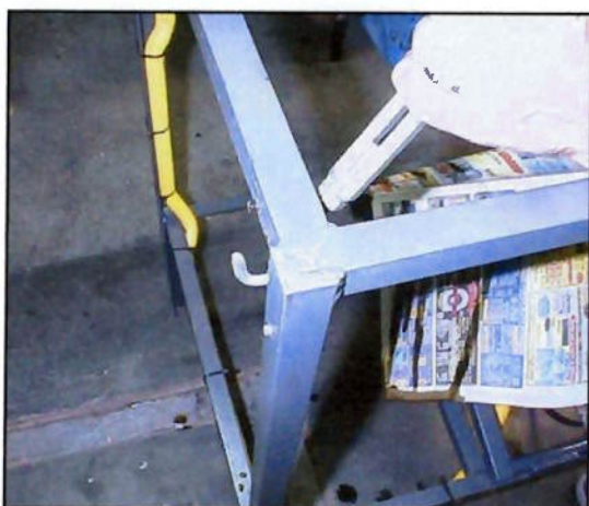
Figura 5.12.1 – Encaixe do esticador da polia no rasco do suporte.
