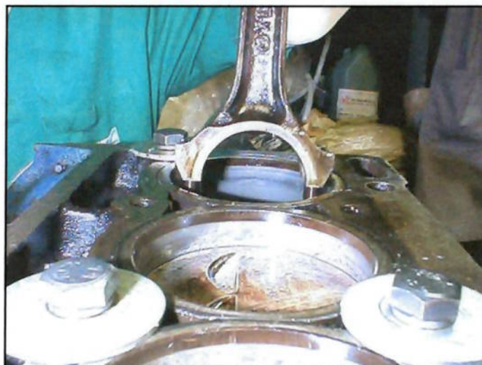
Figura 5.4.3 – Remoção da biela pela parte superior do cilindro.
