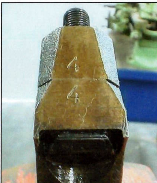
Figura 5.10.1 – Numeração da biela e sua capa, que deve coincidir.
