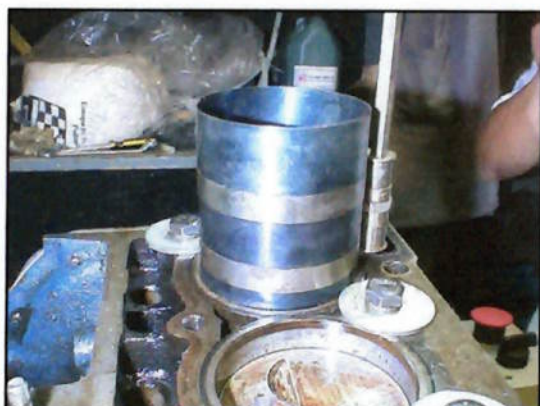
Figura 5.9.1 – Colocação do pistão e anéis com a cinta de montagem.
