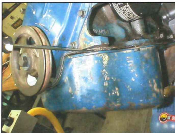
Figura 5.3.2 – Desacoplamento do cárter com a ajuda de uma chave de fenda.
