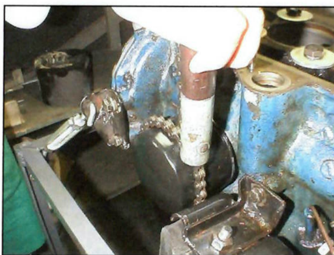
Figura 5.13.1 – Remoção do filtro de óleo com a chave de laço.
