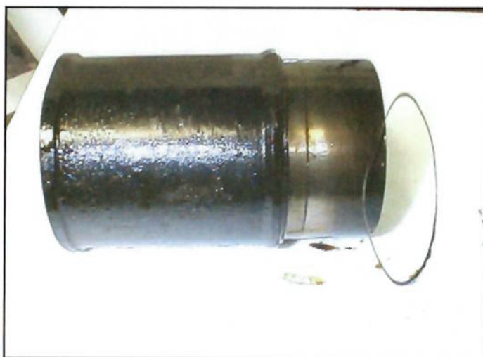
Figura 5.5.3 – Camisa do cilindro com suas arruelas de calço.
