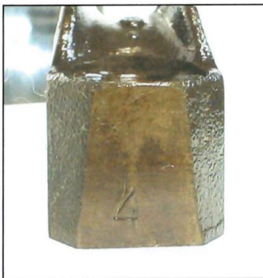
Figura 5.4.2 – Número do cilindro gravado na capa de biela.
