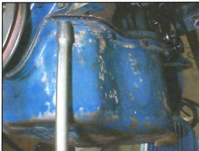
Figura 5.3.1 – Remoção dos parafusos do cárter com a chave de 10mm.
